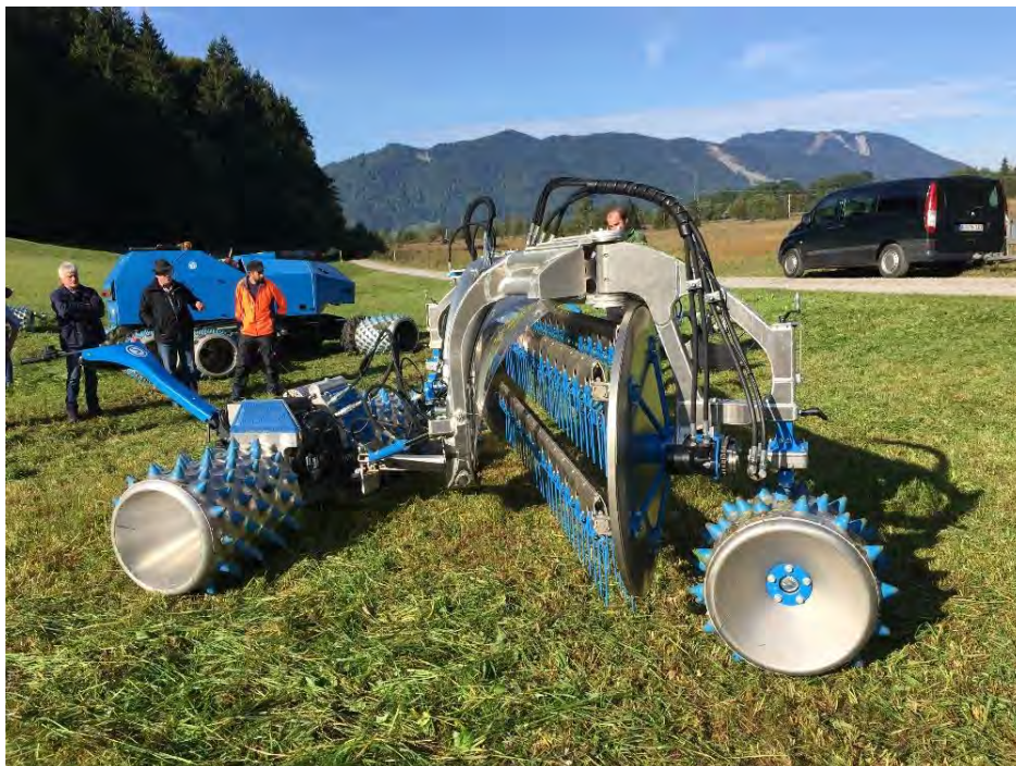
Abb. 71 Neuartige Maschinen (Kammschwader) zur bodenschonenden Bewirtschaftung der Streuwiesen (Foto: P. Strohwasser).
