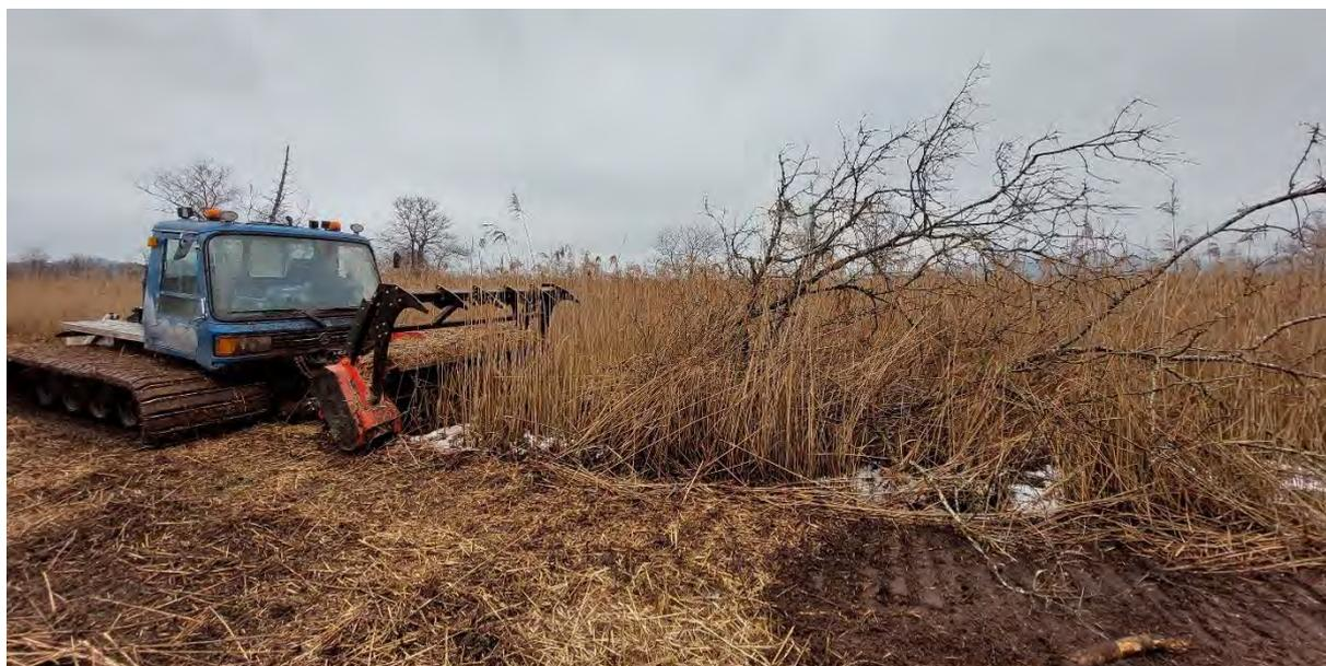
*Abbildung 41: Mit der Mulchraupe können Gehölze gemulcht und deren Stock im selben Arbeitsgang gefräst werden. Auf nassen mit Standorten mit stärkerem Gehölzaufwuchs lässt sich hierdurch boden- und geräteschonend die Mähbarkeit wiederherstellen (Foto: T. Korschefsky)*
